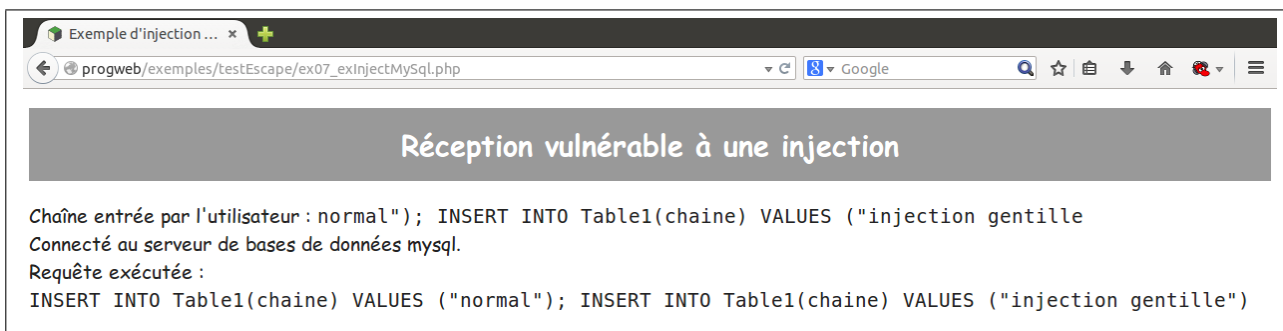
FIGURE 4.10 : Requête exécutée lors de l'injection SQL
