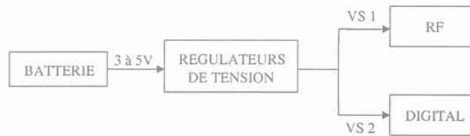
F2.1-1 : Répartition simplifiée des circuits intégrés et des tensions d'alimentation d'un téléphone portable
