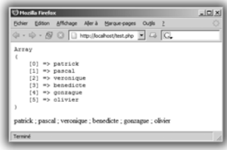
Figure 4.12 : Trois caractères sont ici utilisés pour unir les éléments du tableau au sein de la chaîne
