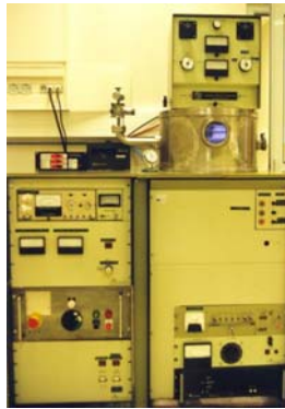
Figure 65 : Bâti MRC de dépôt de métaux et diélectriques par pulvérisation cathodique
